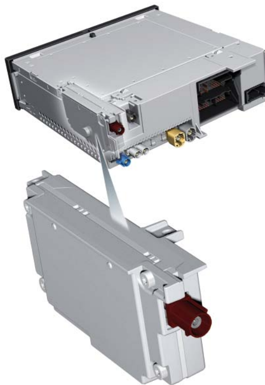
Módulo de teléfono en la J794 618_072
