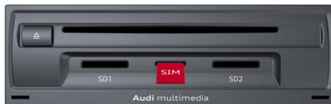
J794 con lector de tarjetas SIM 618_059
