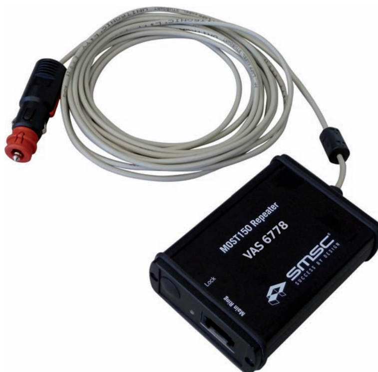
Тестовый блок управления для оптической шины VAS 6778 618_067
