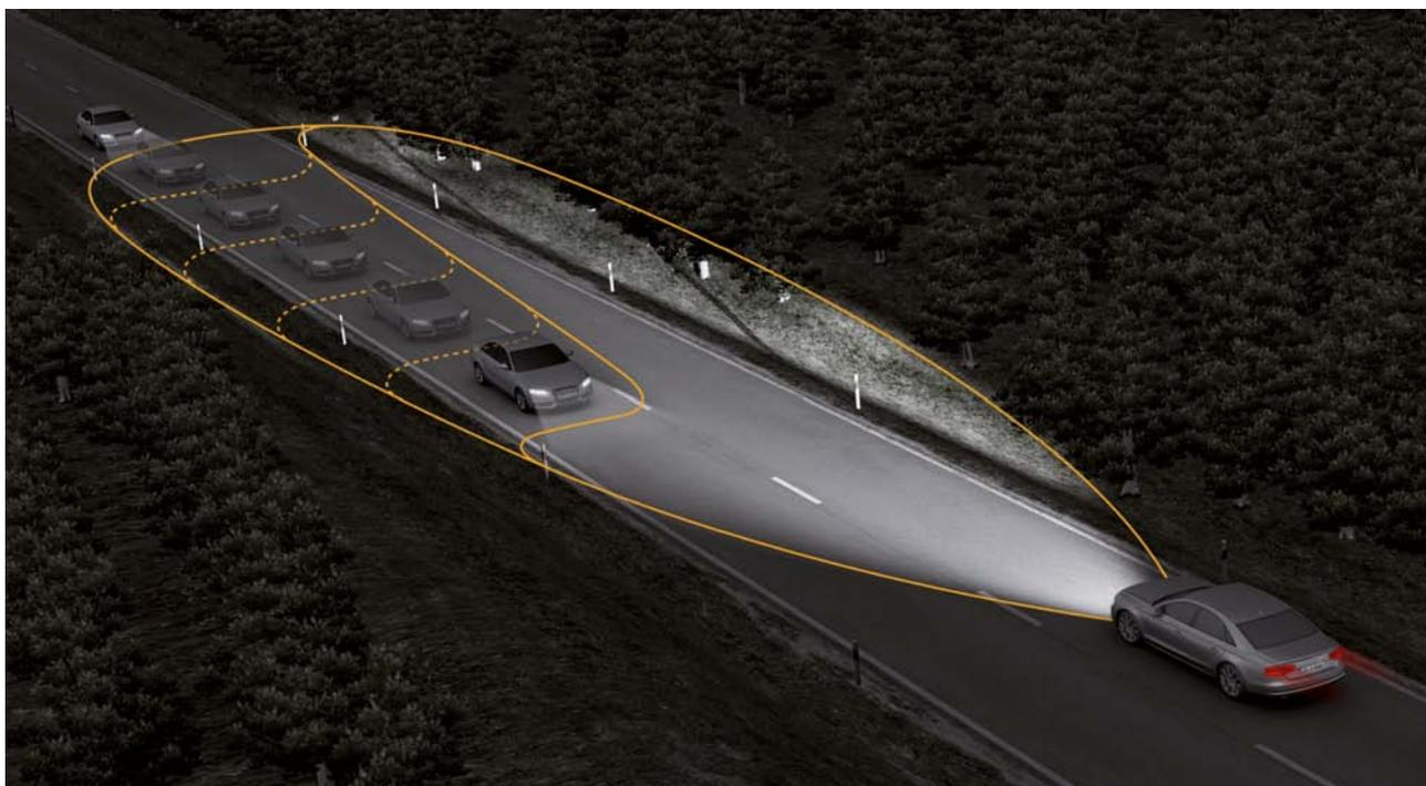
Funktionsprinzip der Gleitenden Leuchtweitenregulierung
