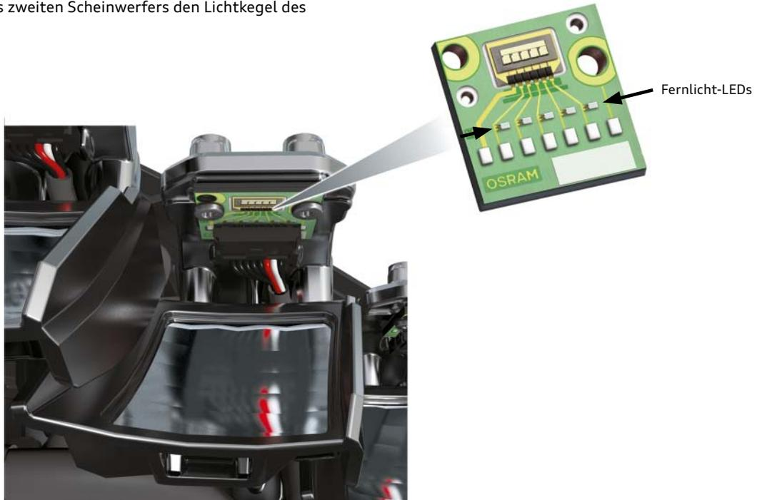
Platine mit Fernlicht-LEDs
