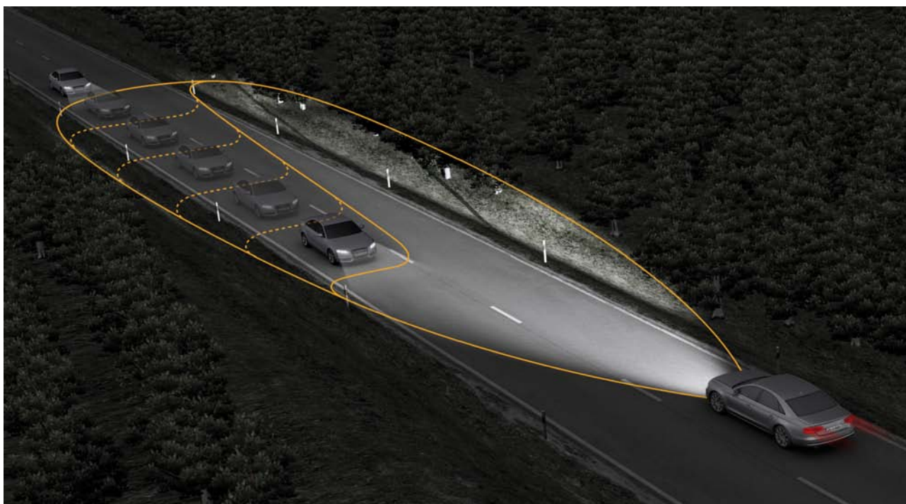
Principio de funcionamiento de la regulación progresiva del alcance de luces
