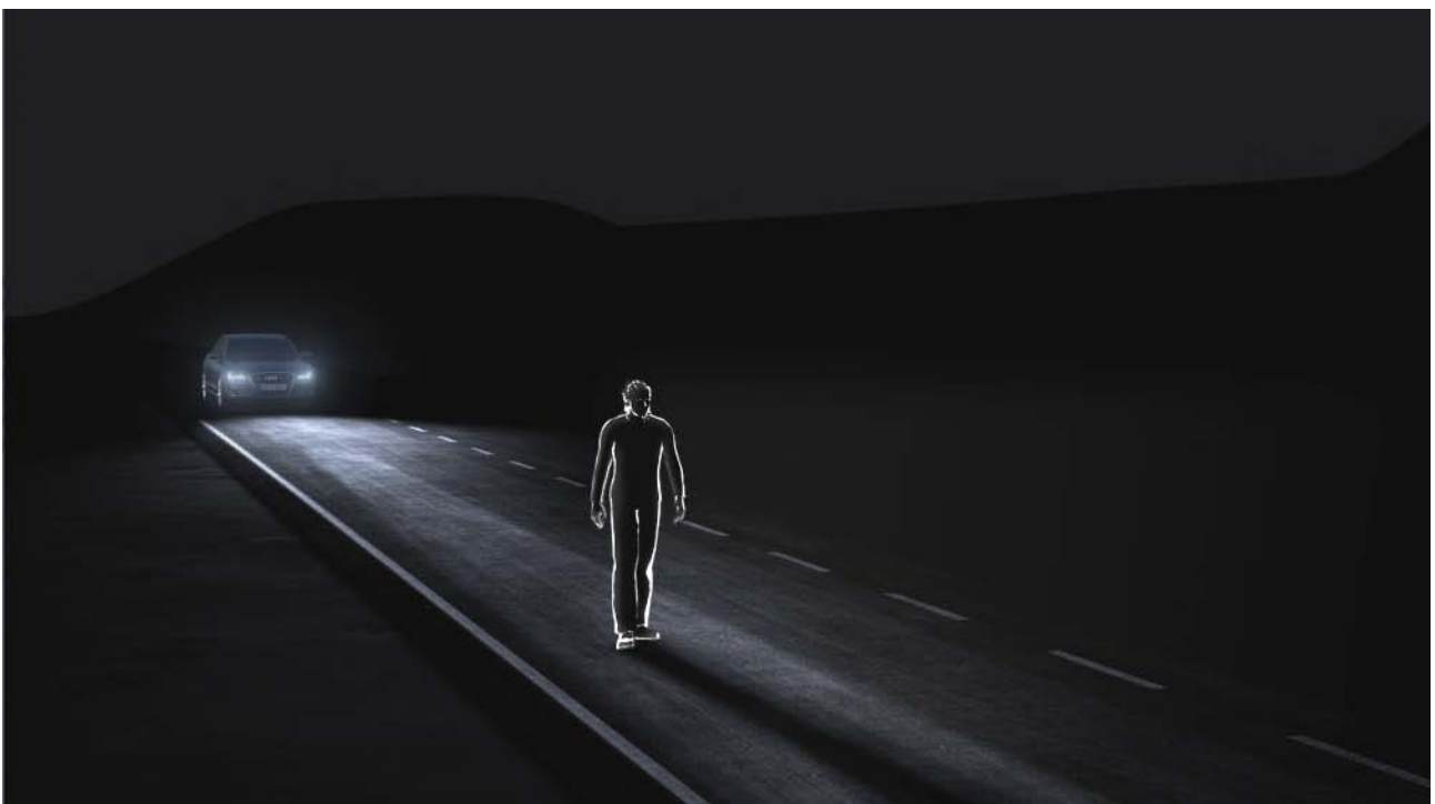
Marcación de un peatón detectado por los faros Audi Matrix LED
