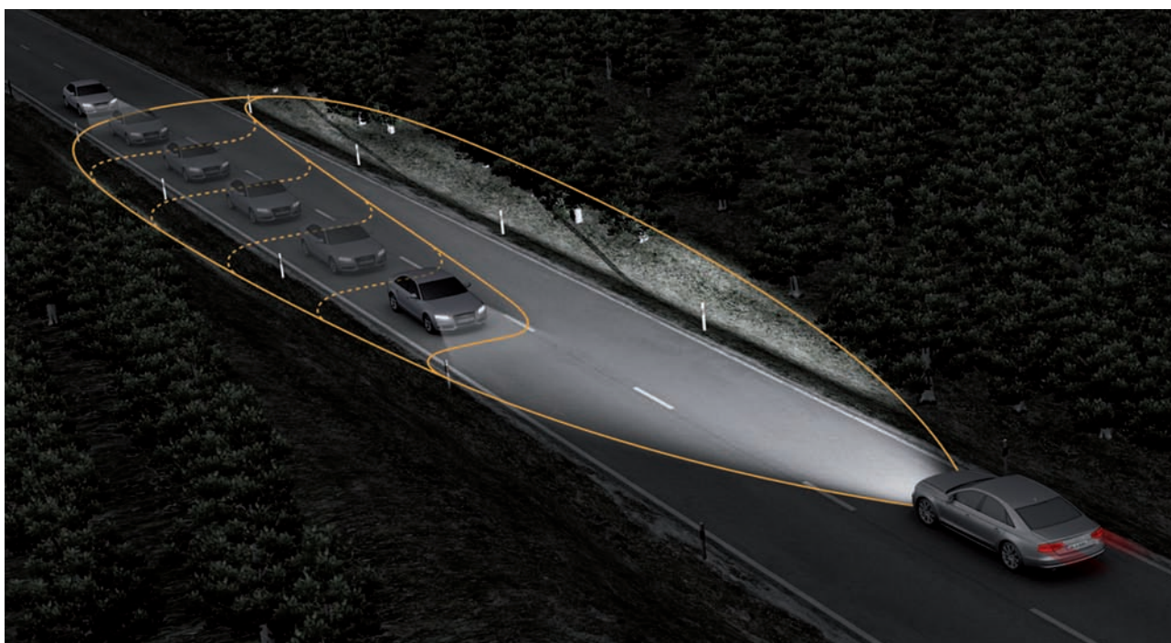
Принцип действия системы плавного регулирования дальности света фар
