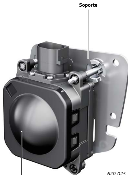
Lente con calefacción integrada Sensores del ACC
