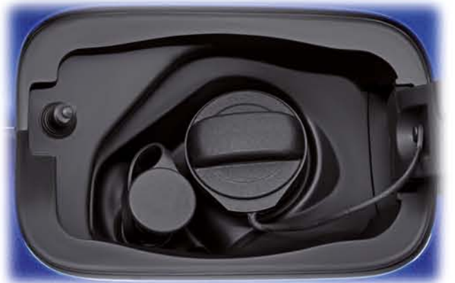
Gaseinfüllstutzen für Erdgas und Tankeinfüllstutzen für Benzin
