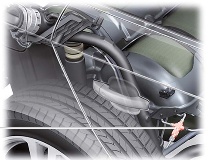
Verteilerstück mit Rückschlagventil
