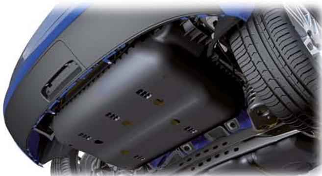
Abdeckung der Erdgas-Kraftstoffbehälter und Stoßfänger ohne sichtbare Abgasanlage
