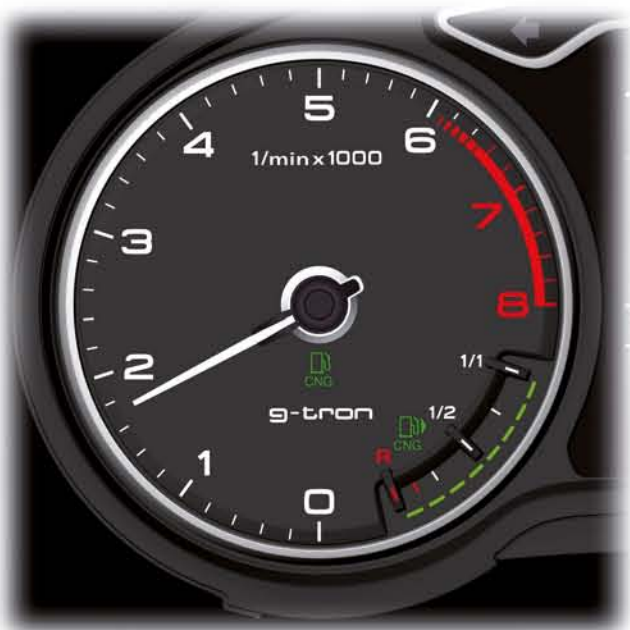
g-tron-Schriftzug im Schalttafeleinsatz und Kraftstoffvorratsanzeige für Erdgas
