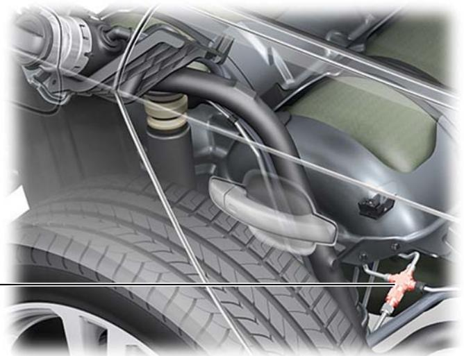
Pieza distribuidora con válvula de retención
