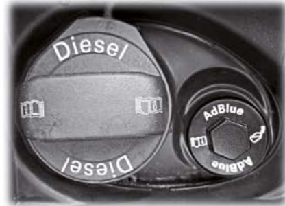
Einfüllstutzen für Diesel bzw. Reduktionsmittel
