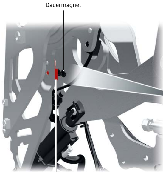
Schalter für Verdeck abgelegt F171
