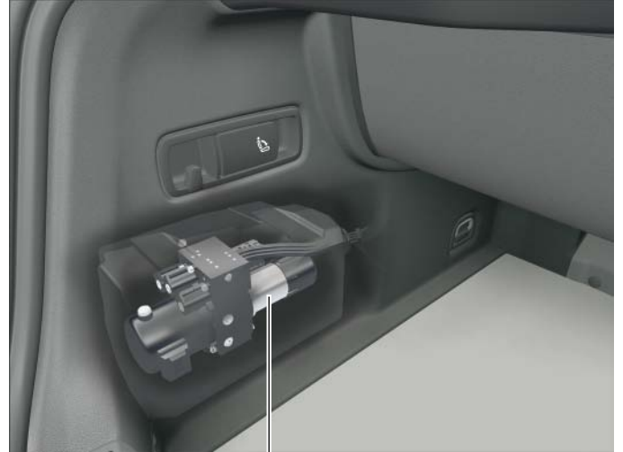
Bomba hidráulica para accionamiento de la capota V118
