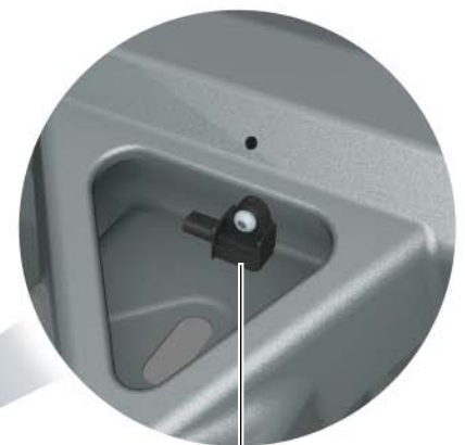
Sensor de impacto para el airbag lateral trasero del lado del conductor G256
