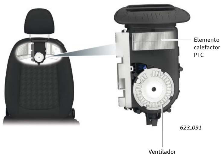
Unidad de control de la calefacción para la zona de la cabeza J846/J847
