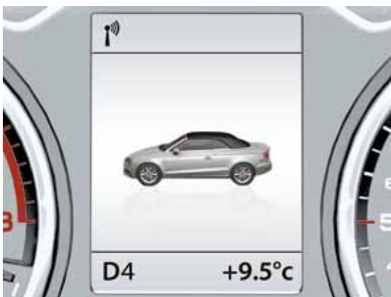
Закрывание завершено, крыша закрыта
