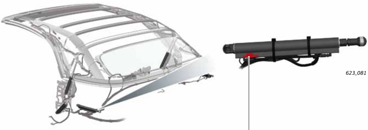
Выключатель крышки короба складной крыши, открыта 407, установленный в гидроцилиндре
