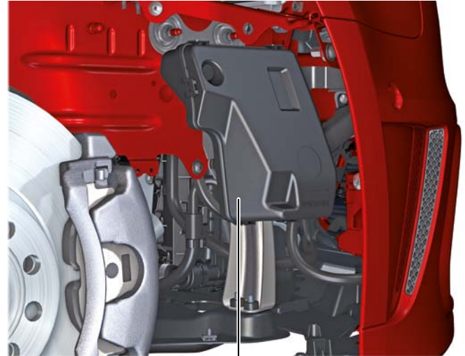
Aktuator 1 für Motorgeräuscherzeugung R257
