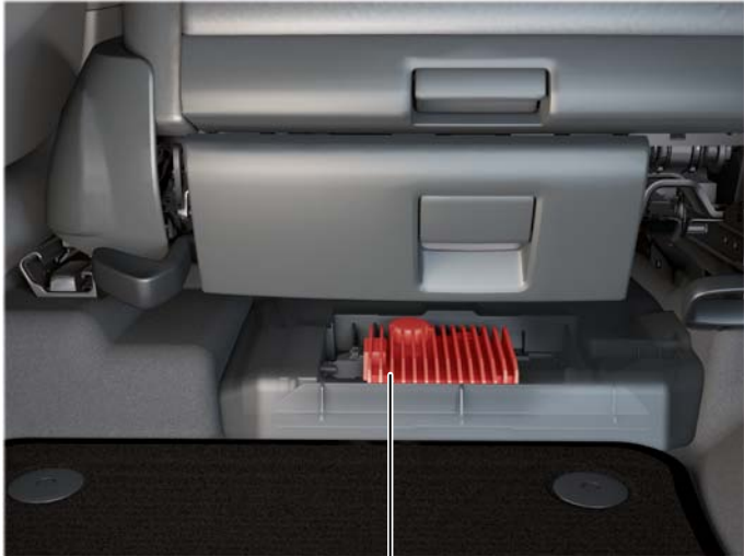
Steuergerät für Motorgeräuscherzeugung J943
