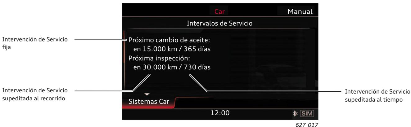
El Audi A3 Sportback e-tron está sujeto fundamentalmente a intervalos fijos de inspección y mantenimiento.
