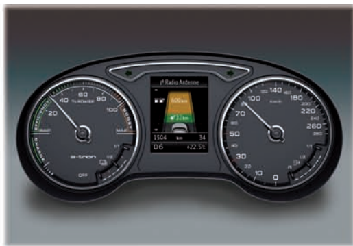
Комбинация приборов с энергометром и индикацией режима e-tron
