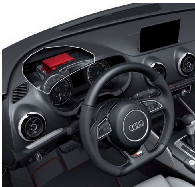
Место установки блока управления J949
