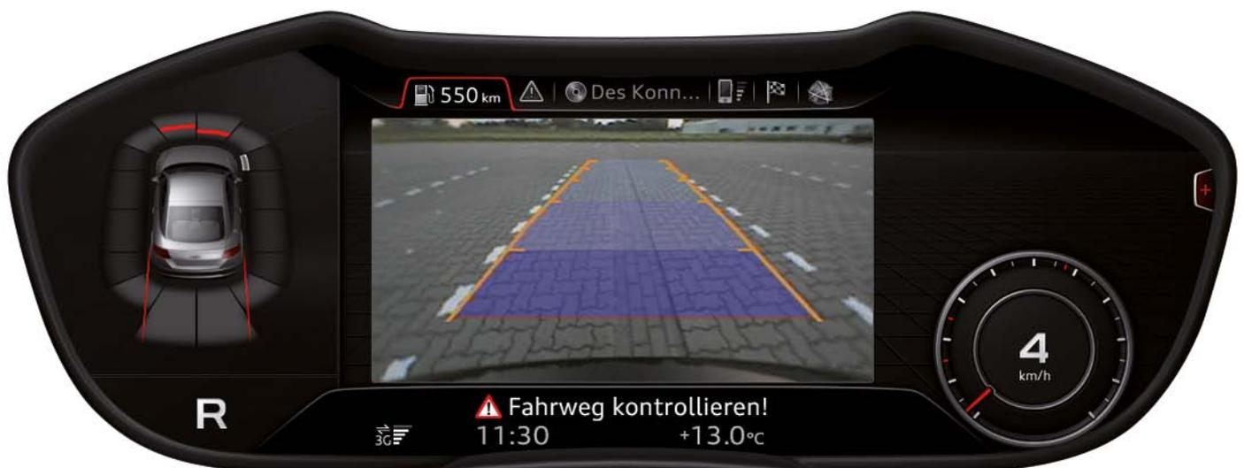
Darstellung des Bilds der Rückfahrkamera im Audi virtual cockpit
