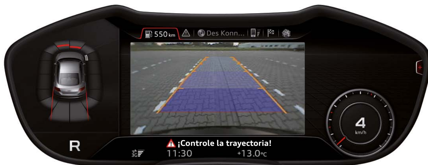
Representación de la imagen de la cámara de marcha atrás en el Audi virtual cockpit
