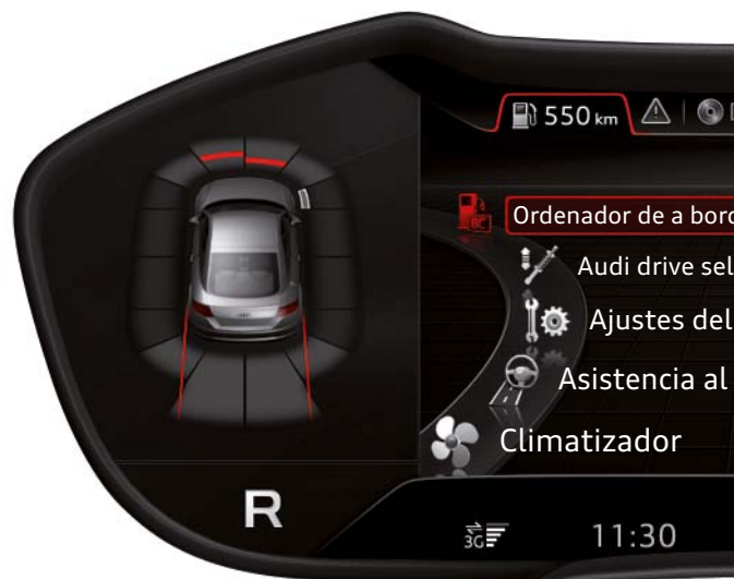
Indicación del Optical Parking System durante la marcha atrás
