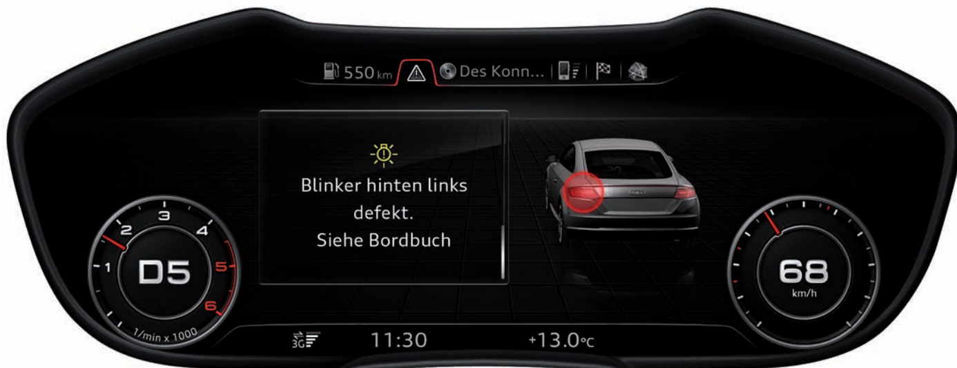
Сообщения о неисправностях во вкладке «Предупреждения» в прогрессивном режиме дисплея
