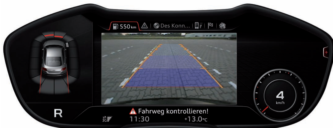
Изображение с камеры ассистента заднего хода в Audi virtual cockpit
