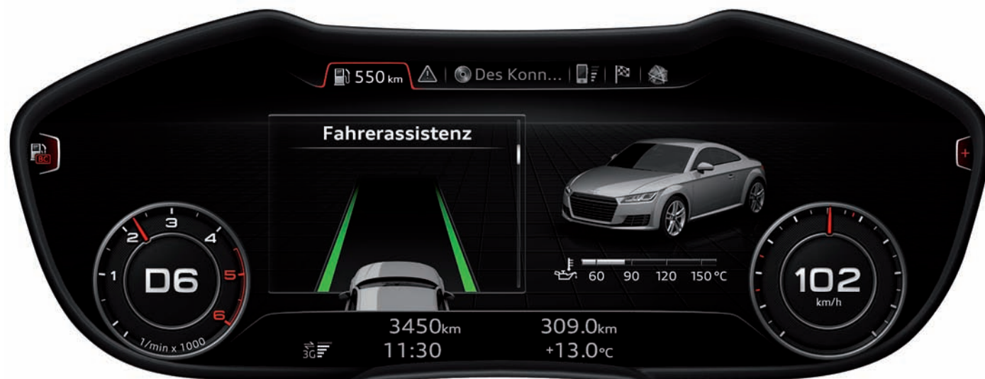
Индикация ассистента движения по полосе Audi active lane assist
