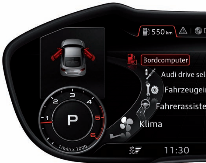
Индикация в Audi TT с открытыми дверями водителя и пассажира
