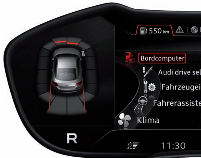
Индикация оптического парковочного ассистента (OPS) при движении задним ходом
