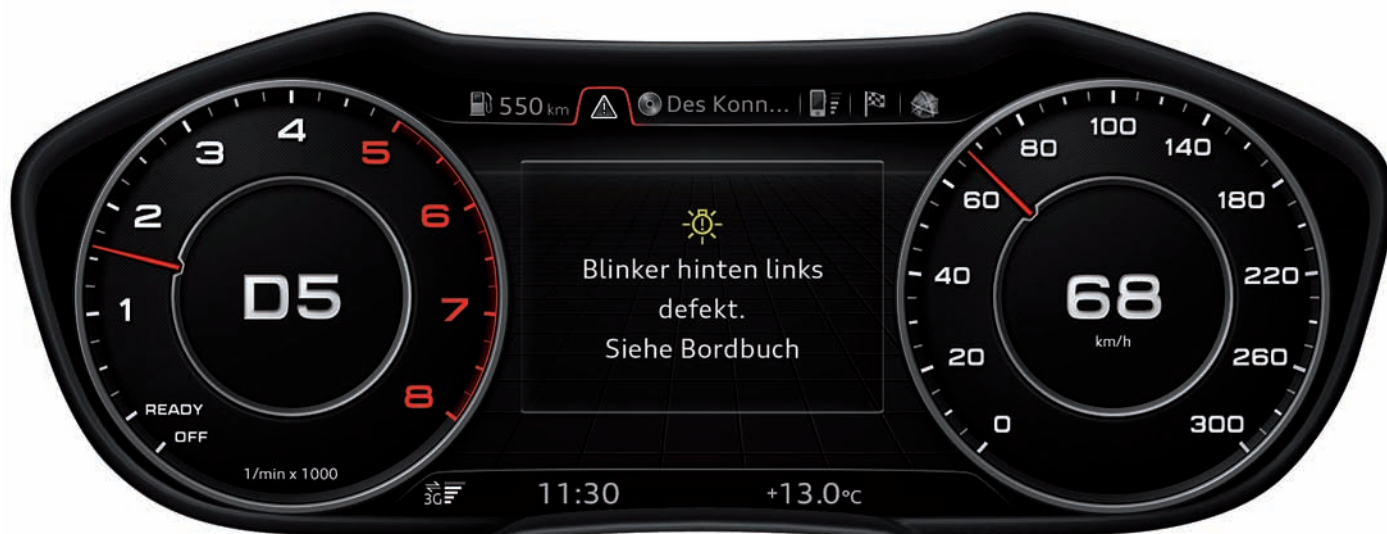
Сообщения о неисправностях во вкладке «Предупреждения» в классическом режиме дисплея
