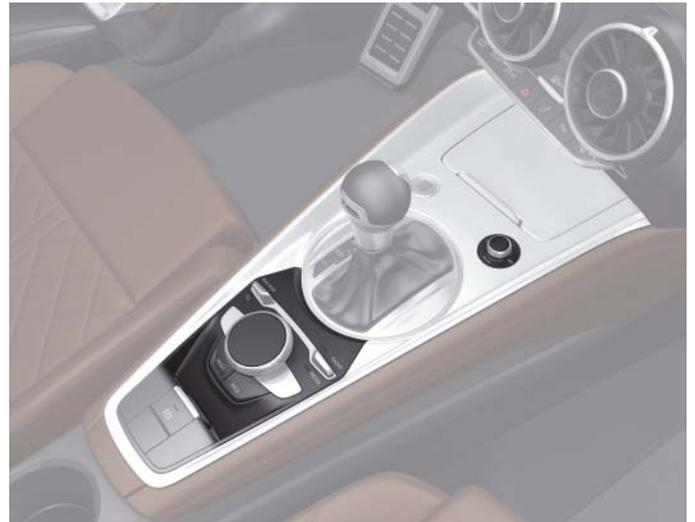
MMI Bedienungseinheit in Mittelkonsole
