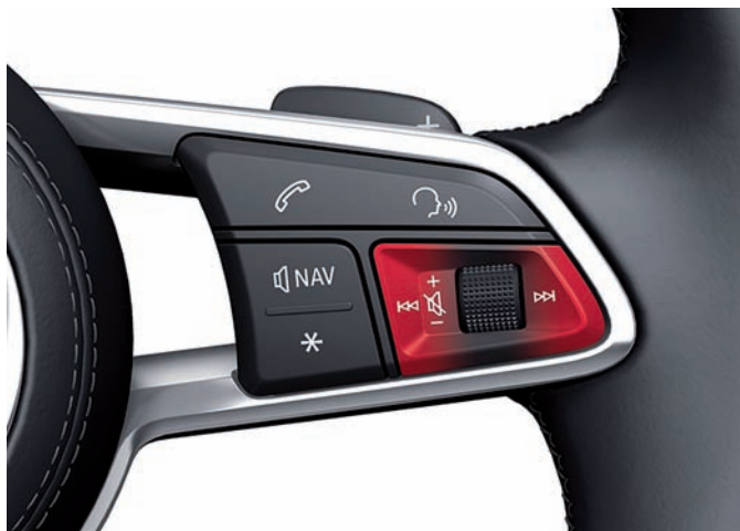
Качающийся переключатель для перехода вперёд или назад
