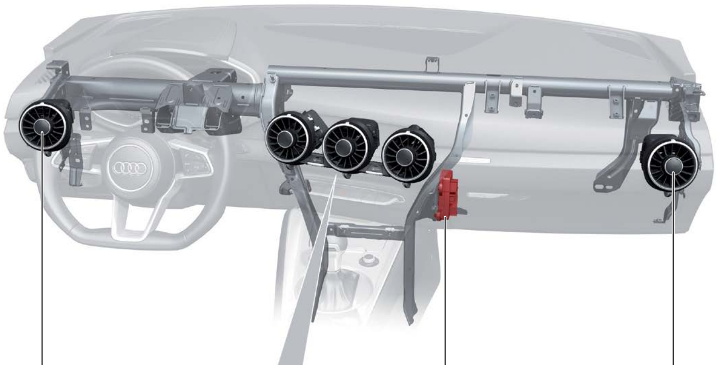
Панель управления и индикации 1 климатической установки E774
