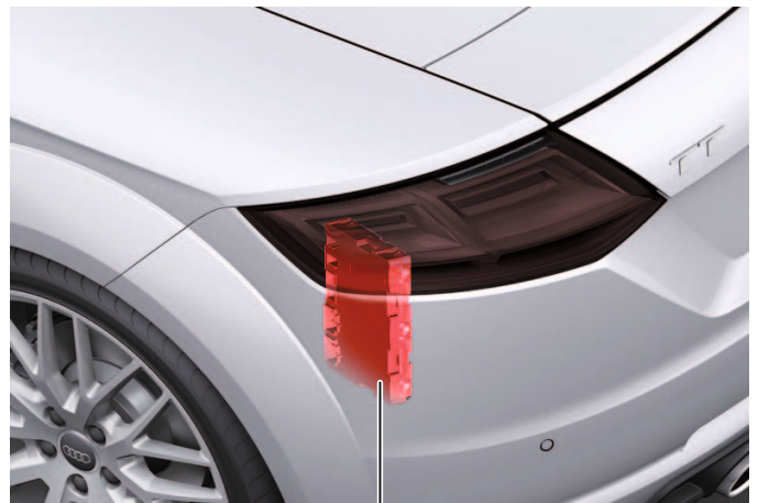
Im Kofferraum links: Steuergerät für Verdeckbetätigung J256
