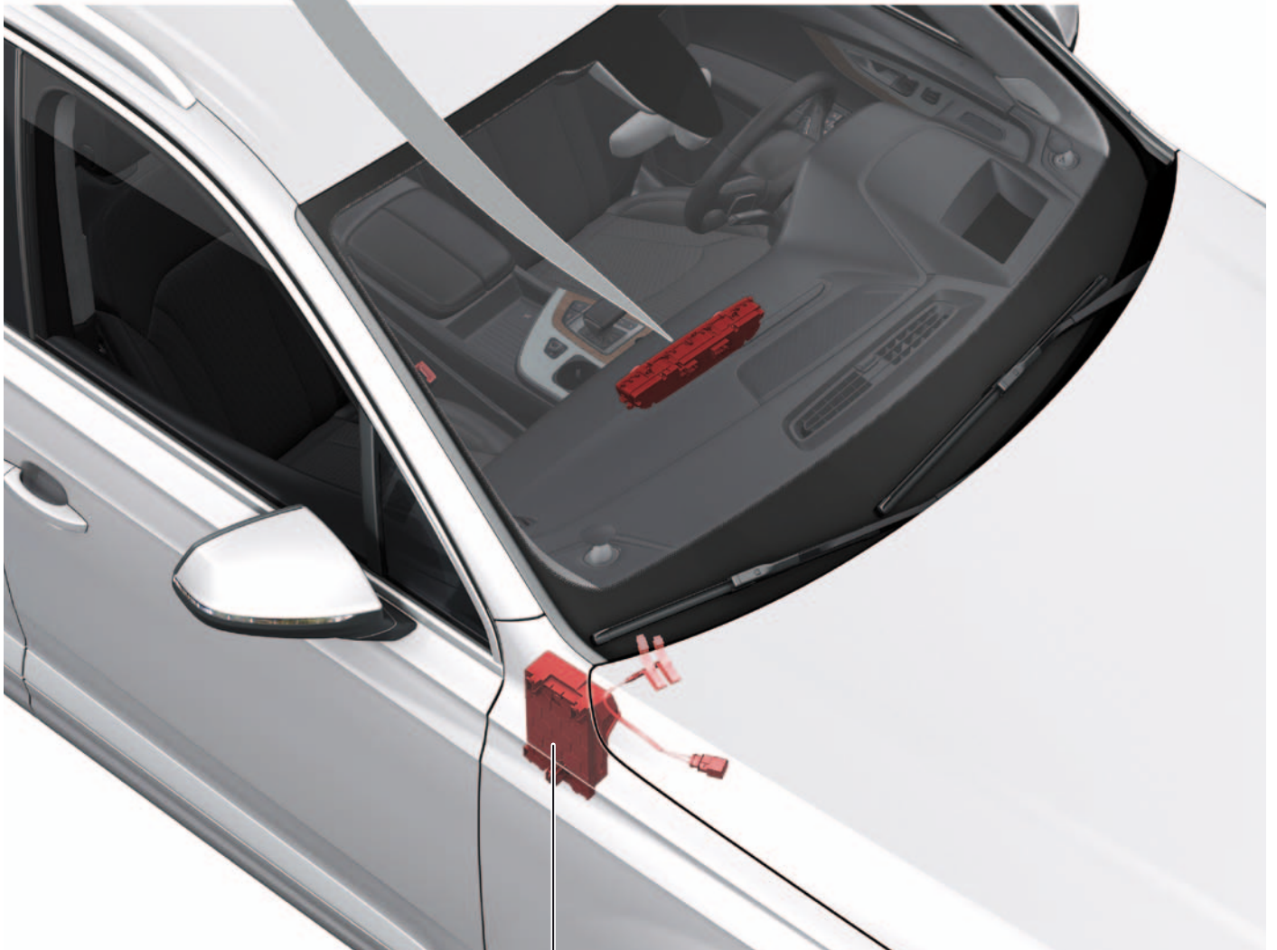
Unidad de control del parabrisas térmico J505 (transformador DC/DC)
