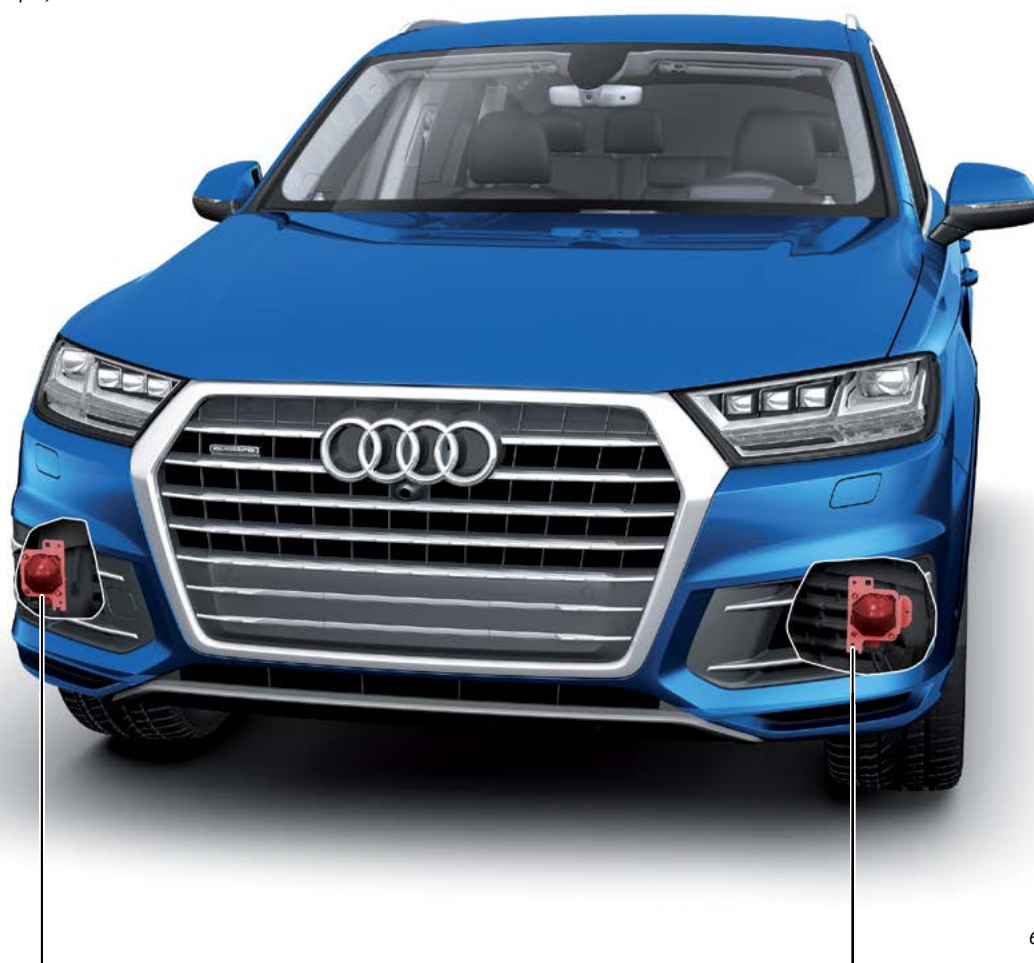
Датчик адаптивного круиз-контроля, правый G259 и БУ адаптивного круиз-контроля J428 (задающее устройство)
