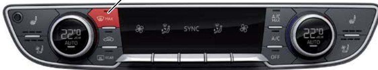
Передняя панель управления и индикации климатической установки E87 с клавишей оттаивания ветрового стекла
