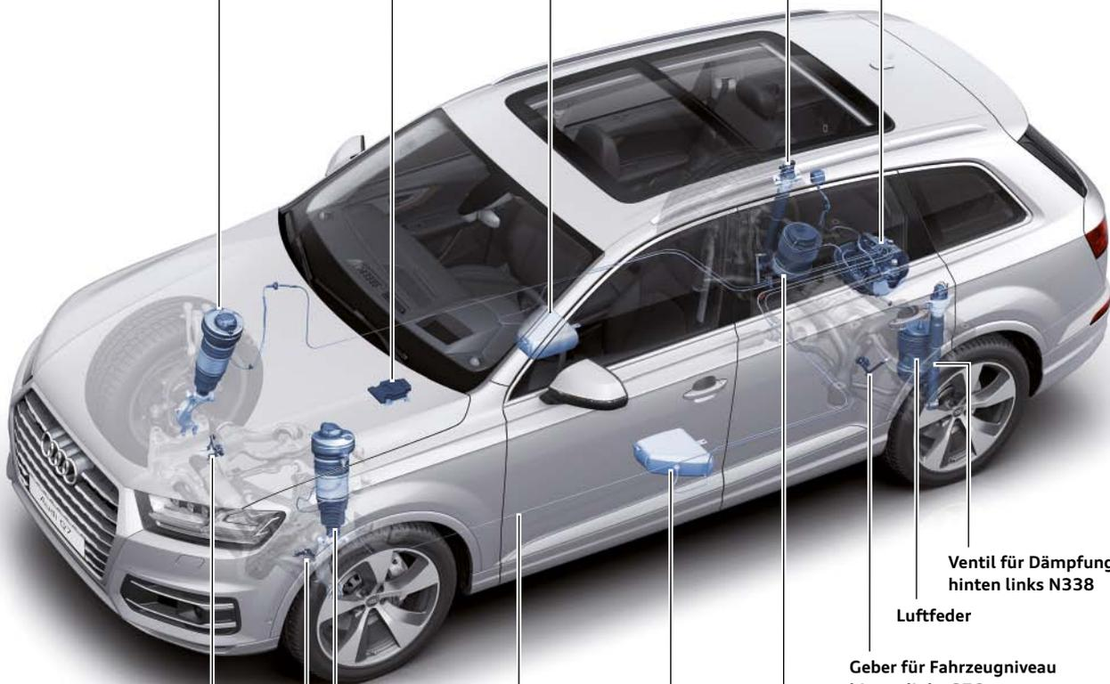
Ventil für Dämpfungsverstellung hinten links N338
