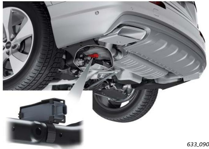
Jeder Sensor besitzt eine eigene Identifikationsnummer (ID), die Bestandteil der gesendeten Funksignale ist. Das Steuergerät „lernt“ selbstständig, welche Sensoren (IDs) zum jeweiligen Fahrzeug gehören. Durch Auswertung der Empfangspegel (Unterscheidung Vorder- und Hinterachse) und der ebenfalls mit dem Funksignal gesendeten Drehrichtung (Unterscheidung linke und rechte Fahrzeugseite) bestimmt das Steuergerät die Positionen der Sensoren im Fahrzeug.
