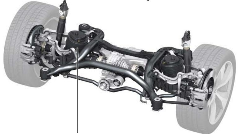
Ajuste de la cota de caída en el punto atornillado entre brazo oscilante del muelle y portagrupos
