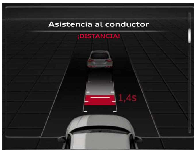
Advertencia de distancia al reducirse la distancia por debajo de la fijada por el conductor
