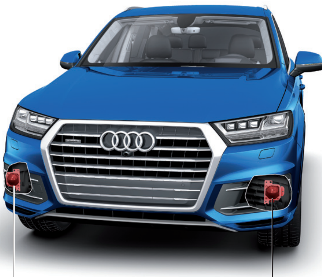
Датчик адаптивного круиз-контроля, правый G259 и БУ адаптивного круиз-контроля J428 (задающее устройство)
