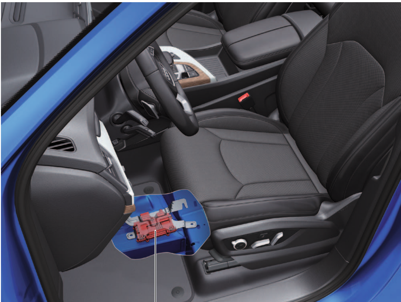
Steuergerät für Nachtsichtsystem J853
