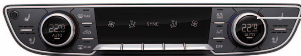
Bedienungs- und Anzeigeeinheit für Klimaanlage vorn E87
