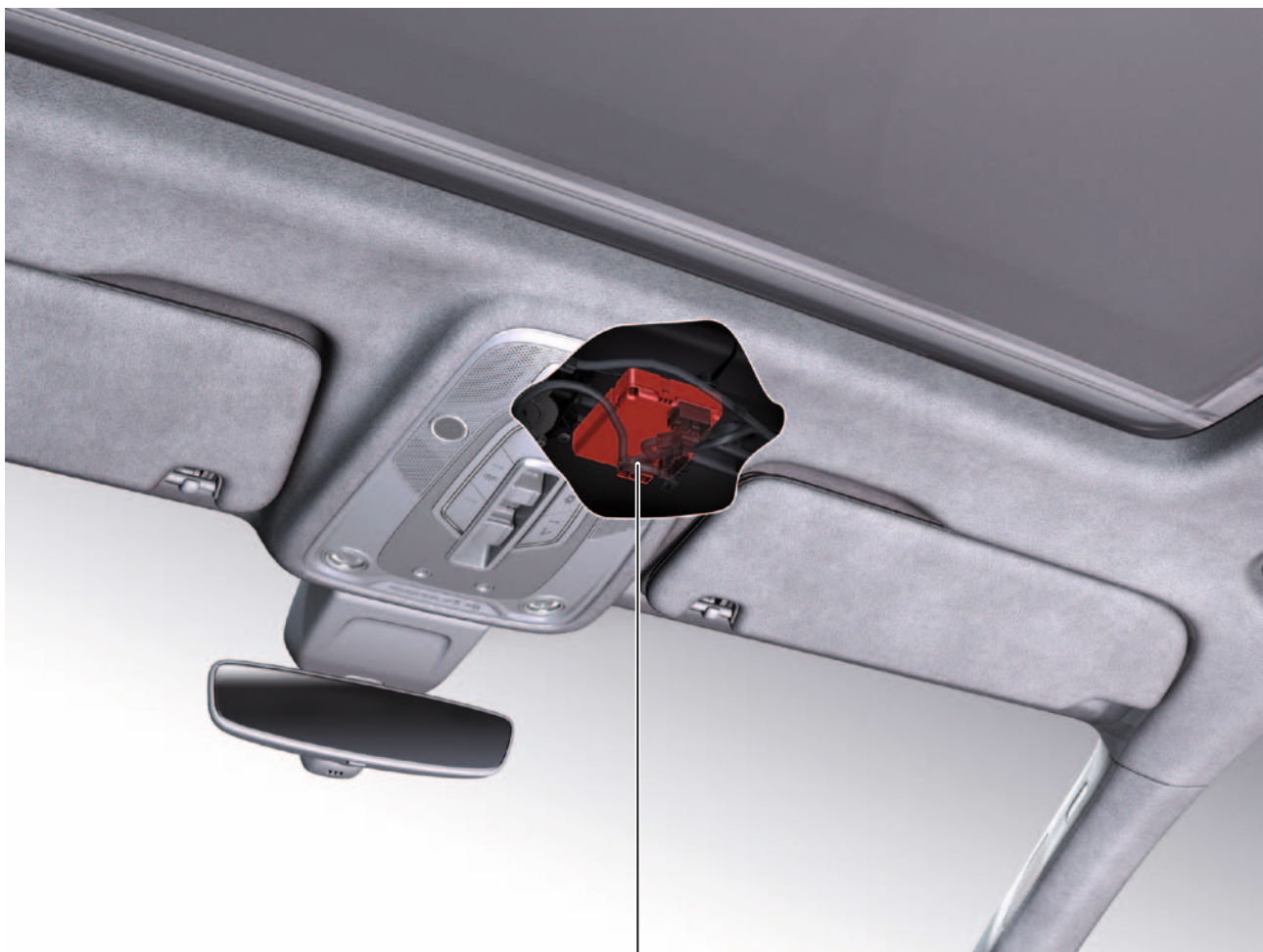
Steuergerät für Schiebedach J245
