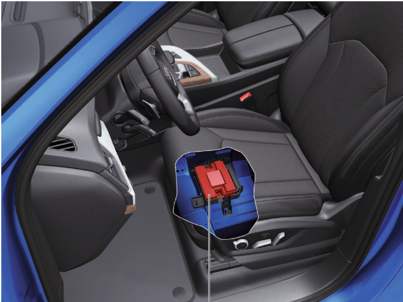
Diagnose-Interface für Datenbus J533
