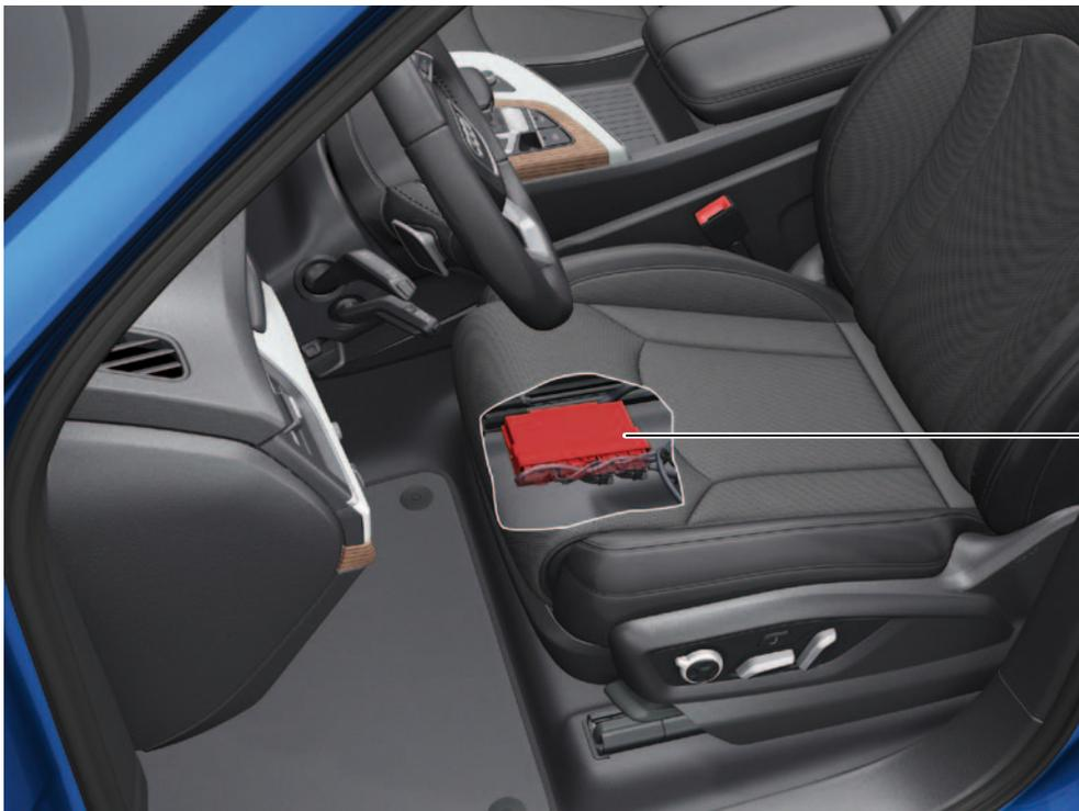
Unidad de control para regulación del asiento y la columna de dirección con función de memoria J136
