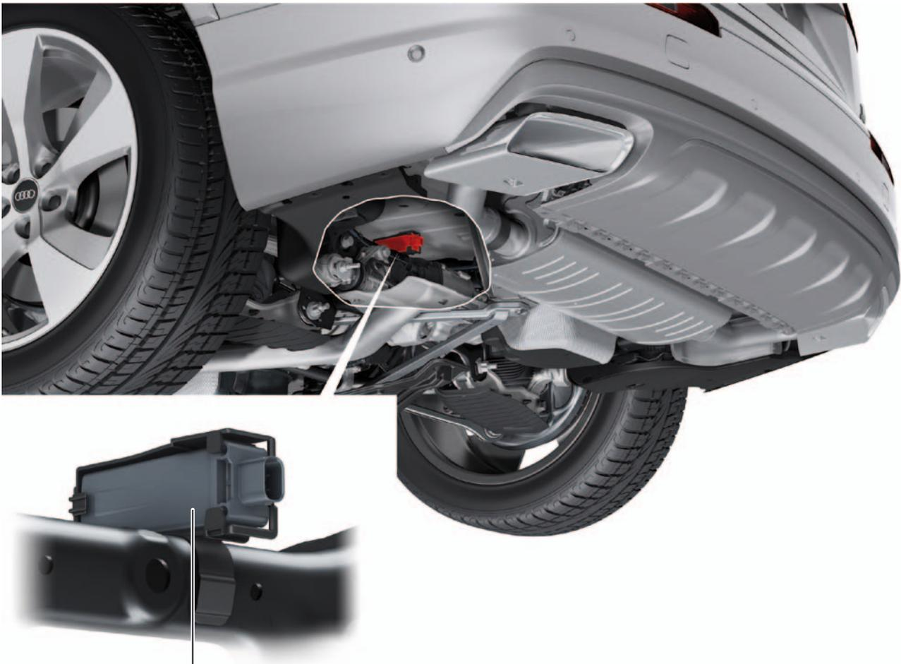
Unidad de control del sistema de control de la presión de los neumáticos J502
