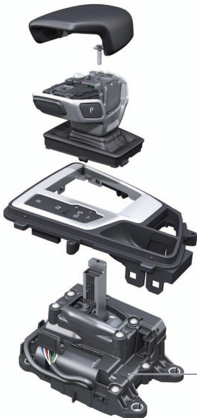
Unidad de control de los sensores de la palanca selectora J587
