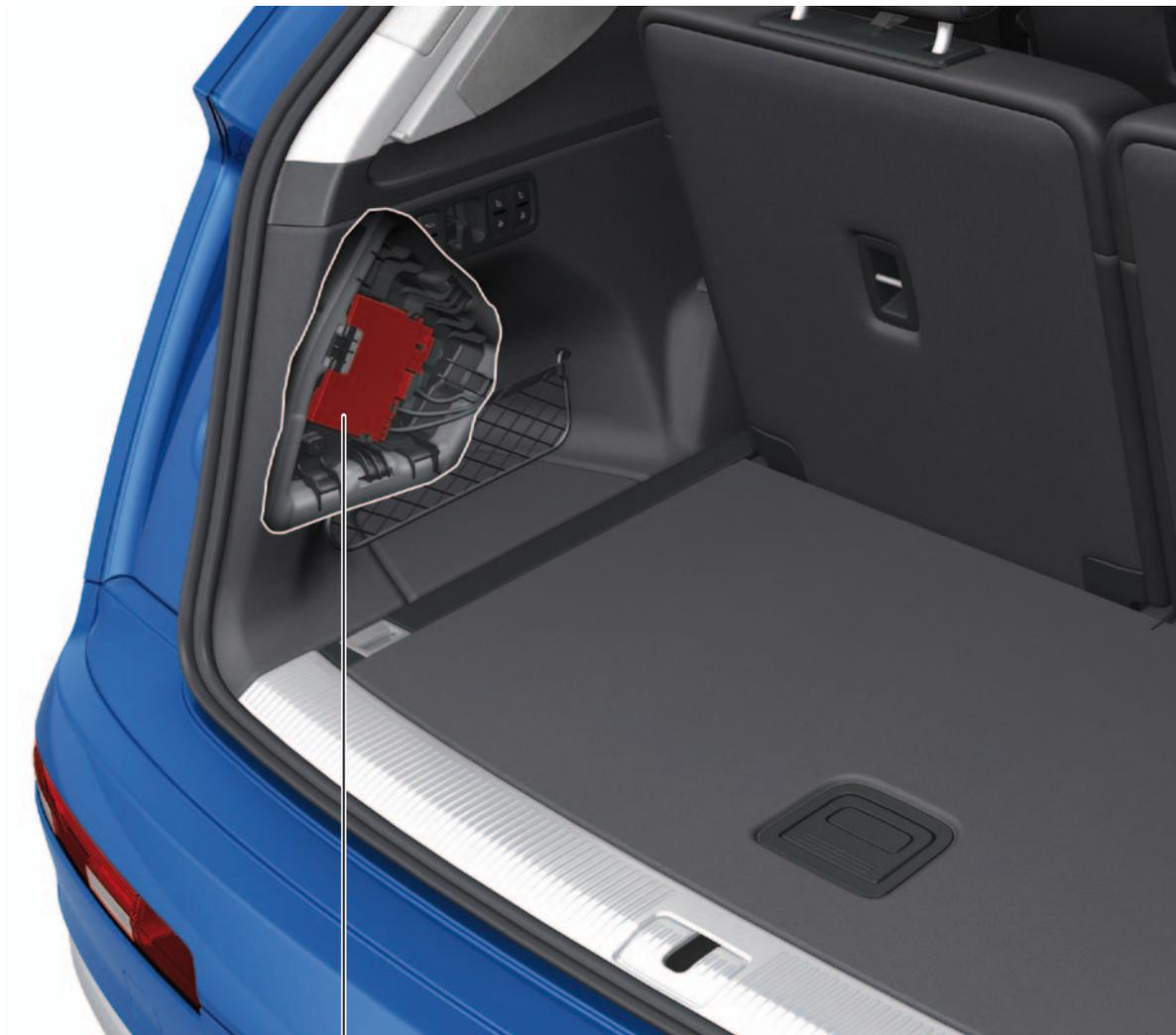
Unidad de control para detección del remolque J345
