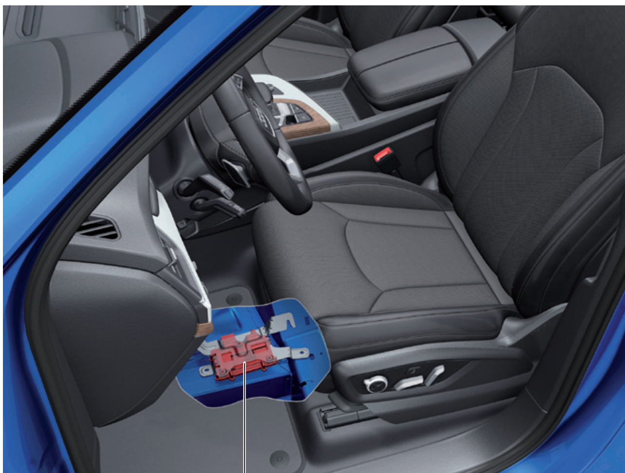
Блок управления системы ночного видения J853
