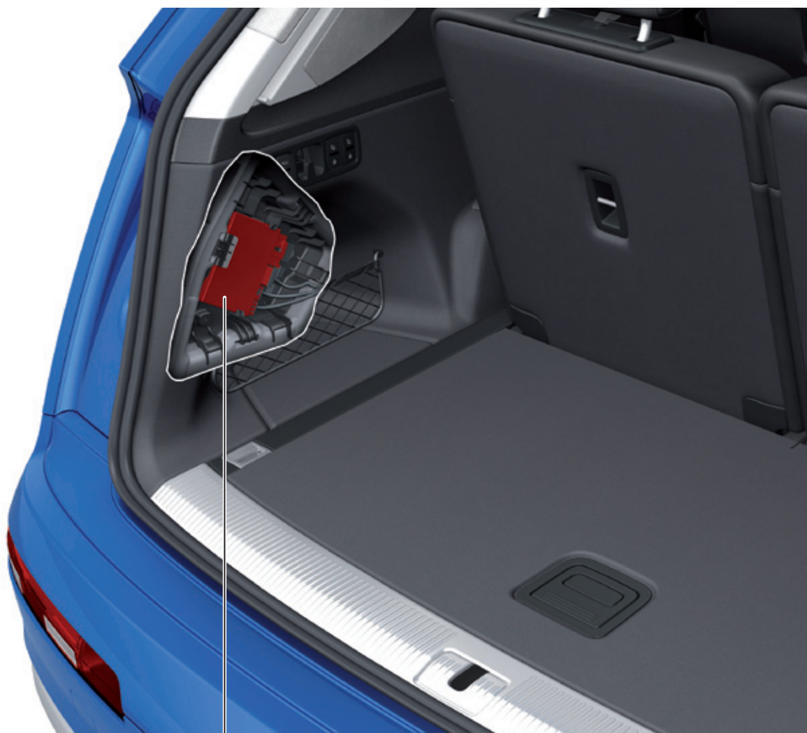
Блок управления распознавания прицепа J345
