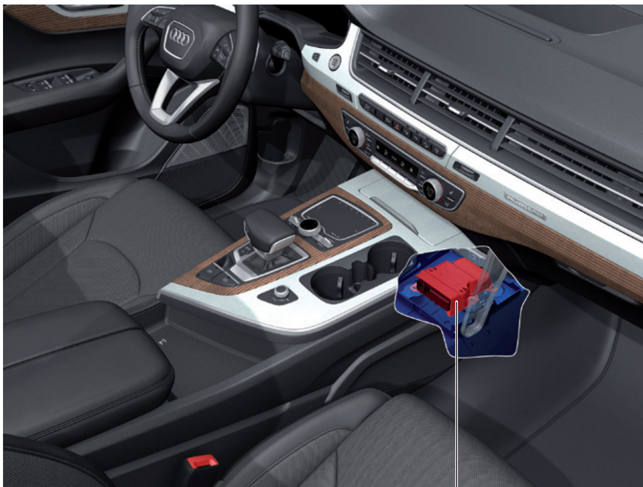
Блок управления подушек безопасности J234
