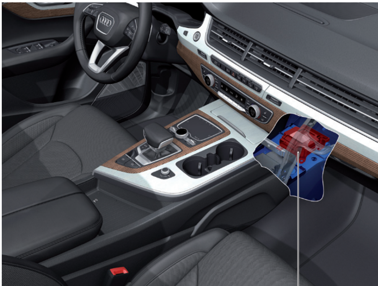
Блок управления ходовой части J775
