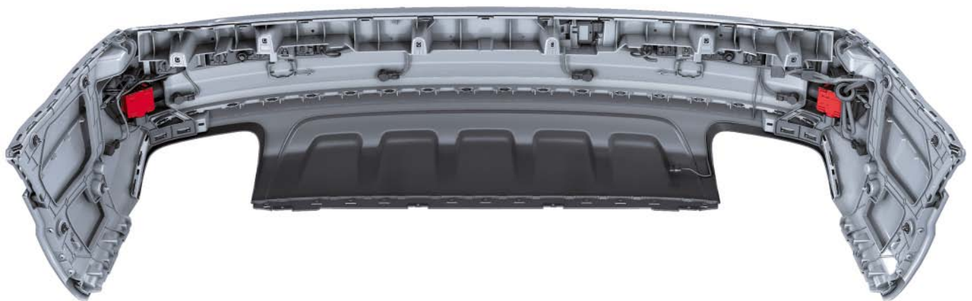
Verbauorte der beiden Radarsensoren am Stoßfängerüberzug
