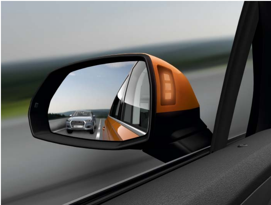
Aktive Warnleuchte des Spurwechselassistenten im linken Außenspiegel
