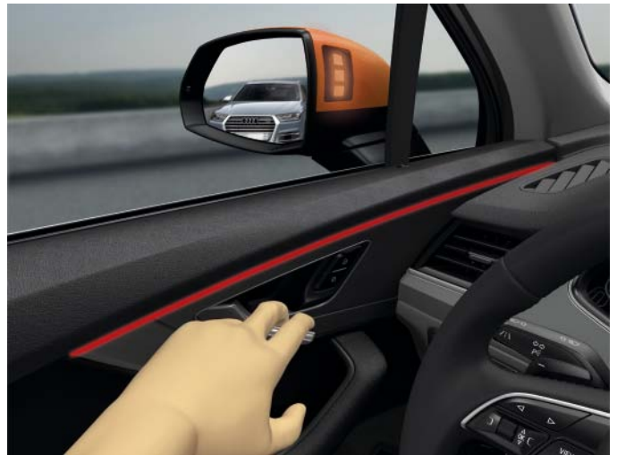
Warnung des Ausstiegsassistenten beim Öffnen der Fahrertür 635_027
