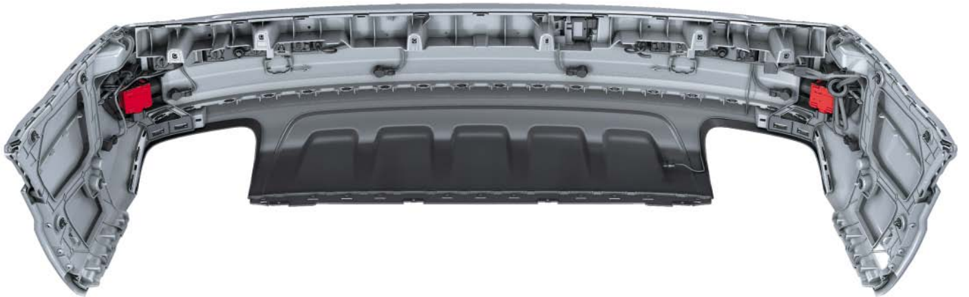
Ubicación de los sensores de radar en el protector del paragolpes
