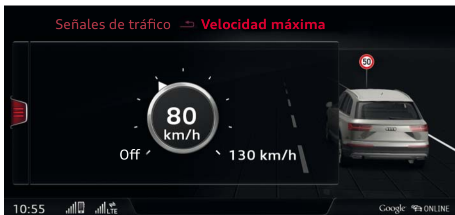
Posibilidad de ajuste de la velocidad máxima para la conducción con remolque
