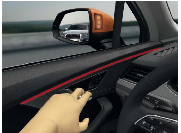
Advertencia del asistente al abrir la puerta del conductor
