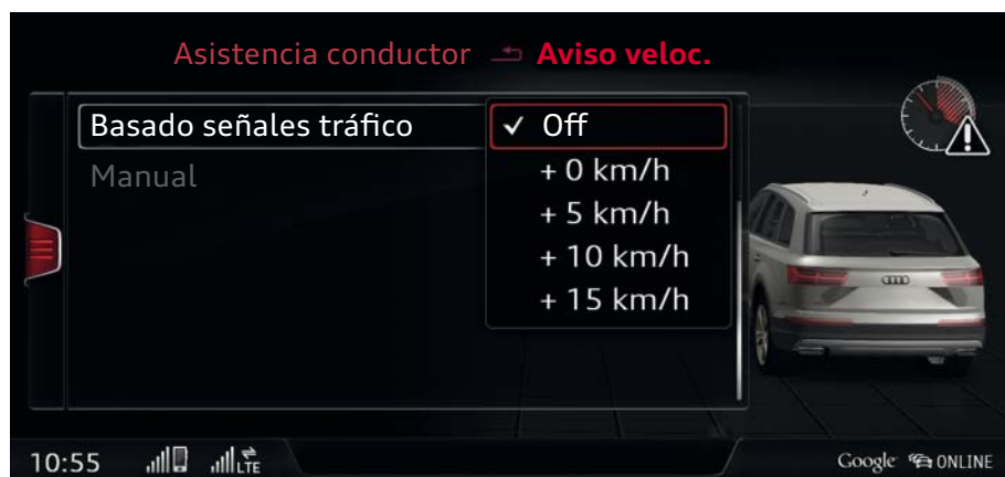
Ajuste del offset de velocidad para el aviso de velocidad basado en las señales de tráfico 635_044
