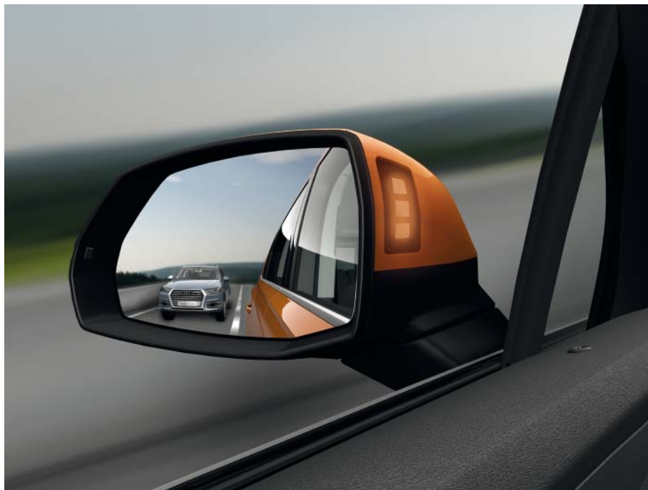
Testigo de advertencia activo del asistente de cambio de carril en el retrovisor exterior izquierdo
