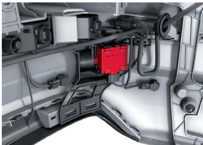
Место установки радарного датчика, заднего левого
