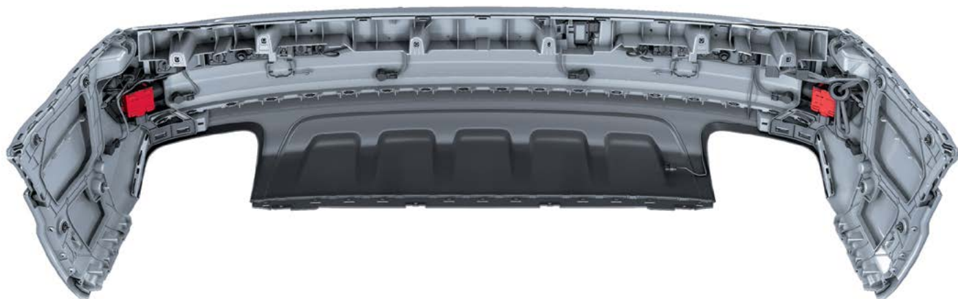
Места установки двух радарных датчиков в облицовке бампера
