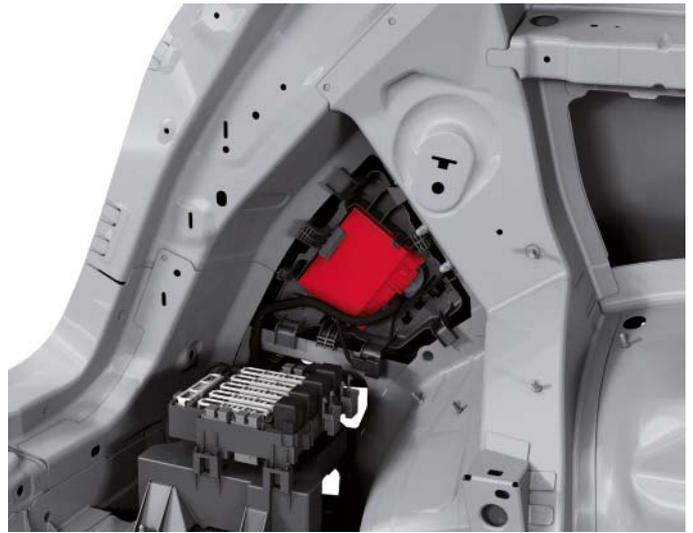
Verbauort Anhängersteuergerät J345
