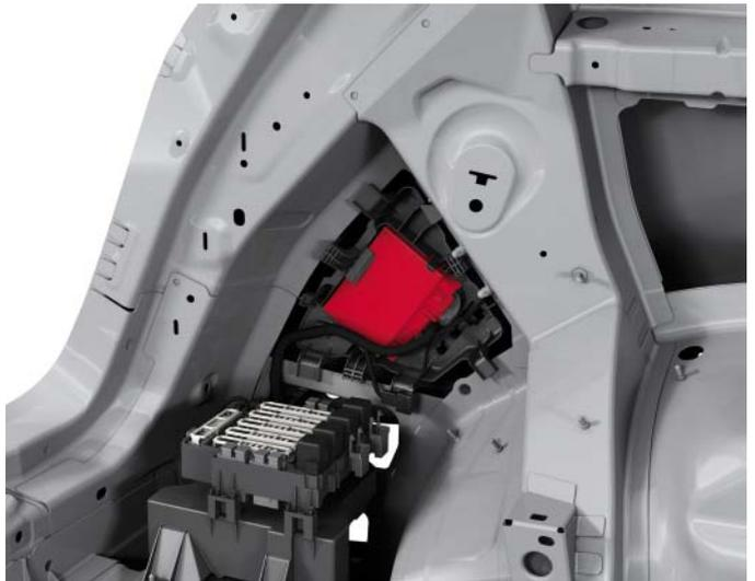
Ubicación de la unidad de control para detección del remolque J345
