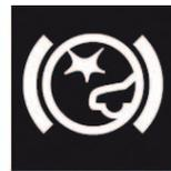
Esta indicación para el conductor se visualiza durante unos 10 segundos después de la conexión del encendido, porque pre sense city no está disponible por el momento. Esto se debe a que la cámara delantera para los sistemas de asistencia al conductor R242 necesita unos 10 segundos hasta estar dispuesta.
