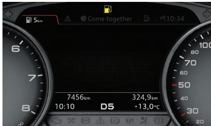
Действующее предупреждение о низком уровне топлива
