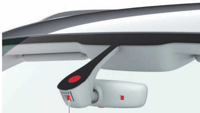
Электрохромное зеркало (вкл. ассистент управления дальним светом) с датчиком освещённости, дождя и влажности воздуха
