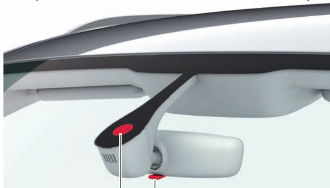
Стандартное, с датчиком освещённости, дождя и влажности воздуха
