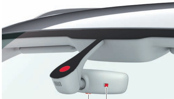
Электрохромное зеркало с датчиком освещённости, дождя и влажности воздуха
