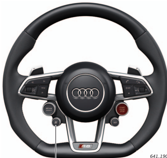
Pulsador Performance con anillo de ajuste para la selección de los modos snow , wet y dry
