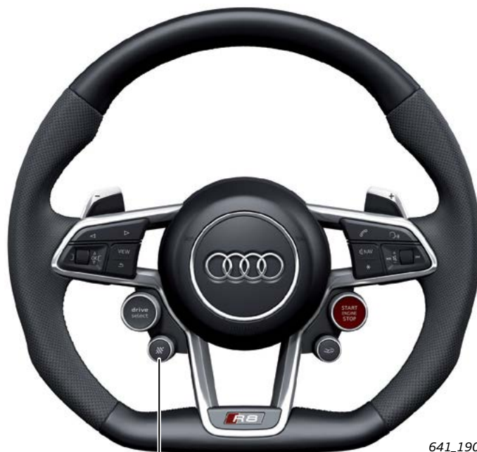
Клавиша Performance с регулировочным кольцом для выбора режимов snow , wet и dry
