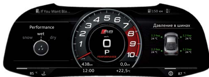
Индикация при настройке Performance-режима wet
