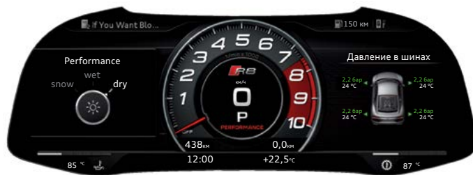
Индикация при настройке Performance-режима dry
