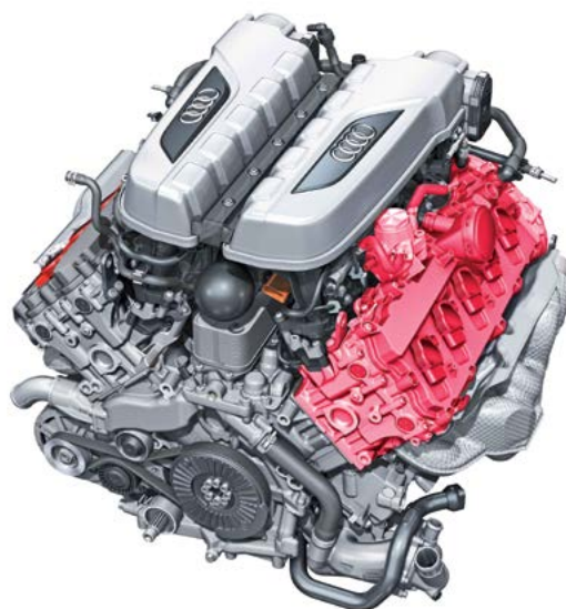
Система отключения цилиндров cylinder on demand
