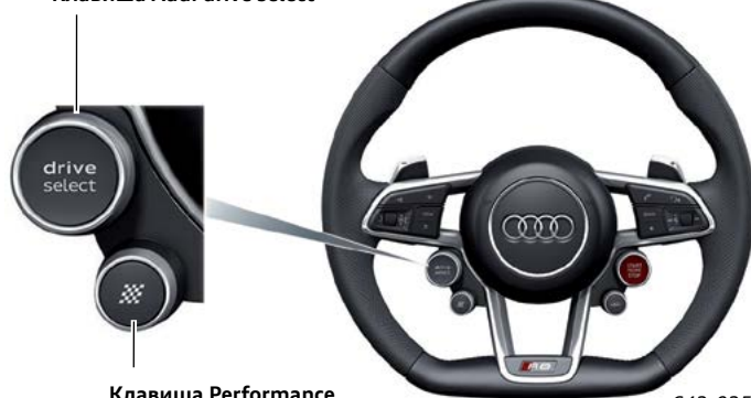
Клавиша Performance с регулировочным кольцом для выбора режимов snow, wet и dry
