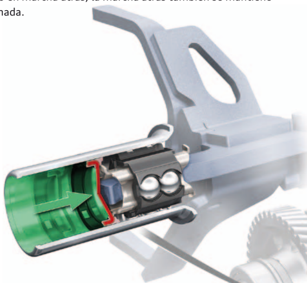
Enclavamiento de la regleta de cambio
