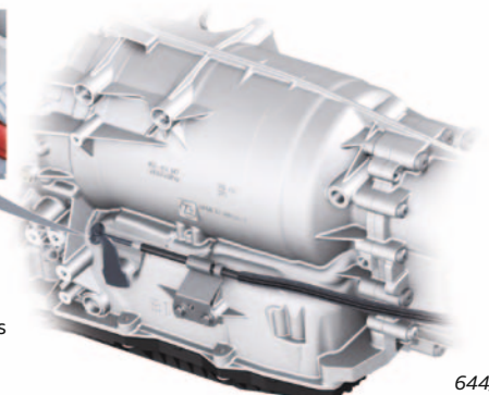
Befestigung des Notentriegelungsseilzugs am OD5-Getriebe
