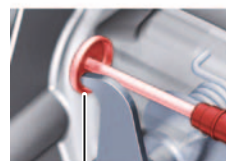
Befestigung des Notentriegelungsseilzugs am OD5-Getriebe
