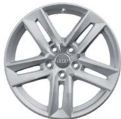
7,0J x 17 ET42 Литой диск Возможна установка цепей противоскольжения 225/50 R17
