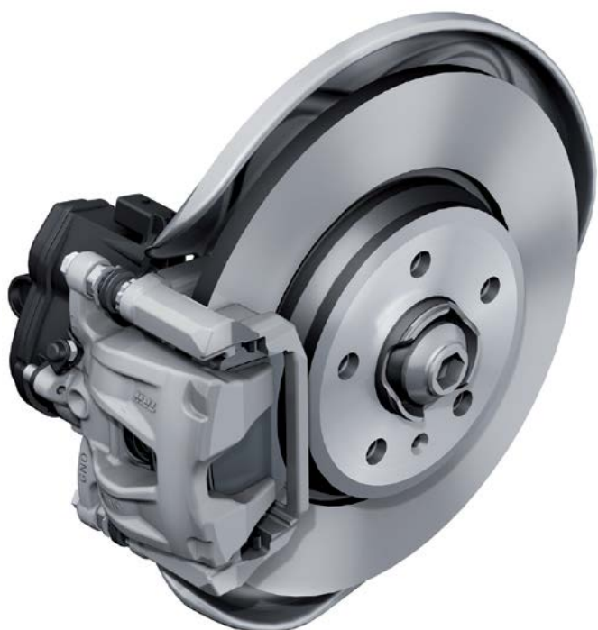
Тормозной механизм 16" TRW PC42 EPBi со сплошным диском
