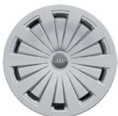
7,0J x 16 ET35 Кованый лёгкий диск Возможна установка цепей противоскольжения 205/60 R16
