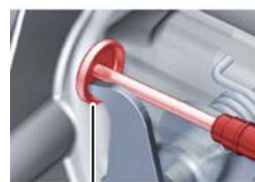
Крепление троса аварийного снятия блокировки трансмиссии на КП OD5
