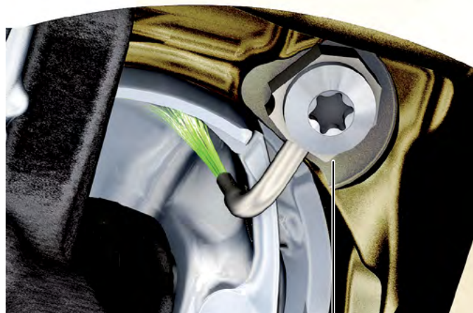
Форсунка охлаждения поршня, требующая установки в определённое положение
