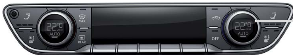
Передняя панель управления и индикации климатической установки E87 (на рис. автоматическая климатическая установка Komfort)
