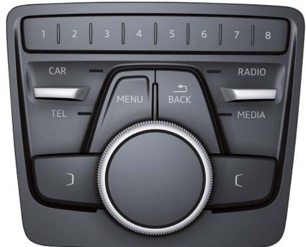
Bedienungseinheit „Basic“ bei Automatikgetriebe
