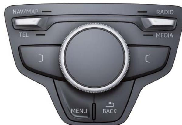
Bedienungseinheit „Mid“ bei Handschaltgetriebe
