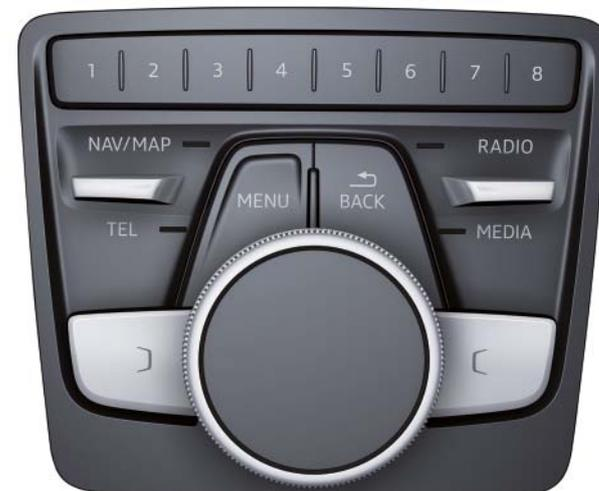
Bedienungseinheit „MMI touch“ bei Automatikgetriebe
