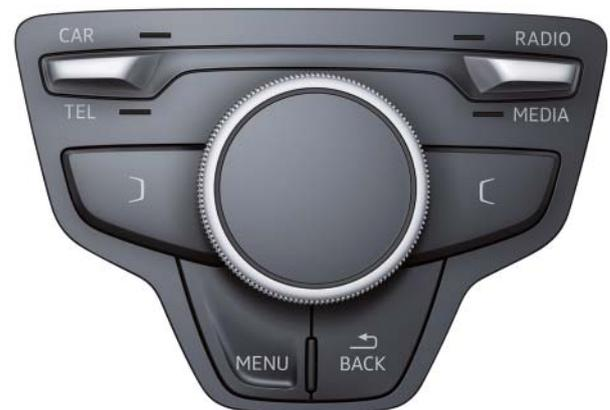
Bedienungseinheit „Basic“ bei Handschaltgetriebe
