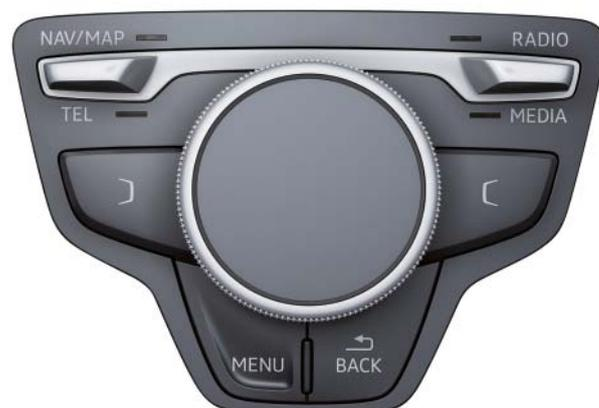
Bedienungseinheit „MMI touch“ bei Handschaltgetriebe
