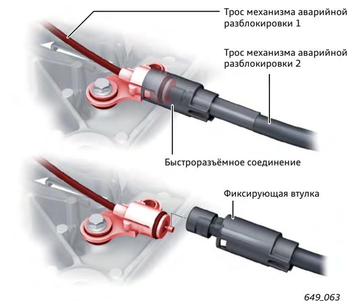
Механизм аварийного отключения блокировки трансмиссии на стоянке предназначен для отключения блокировки, когда требуется более продолжительное нахождение механизма блокировки трансмиссии на стоянке в положении P-OFF, и должен приводиться в действие в следующих случаях:
