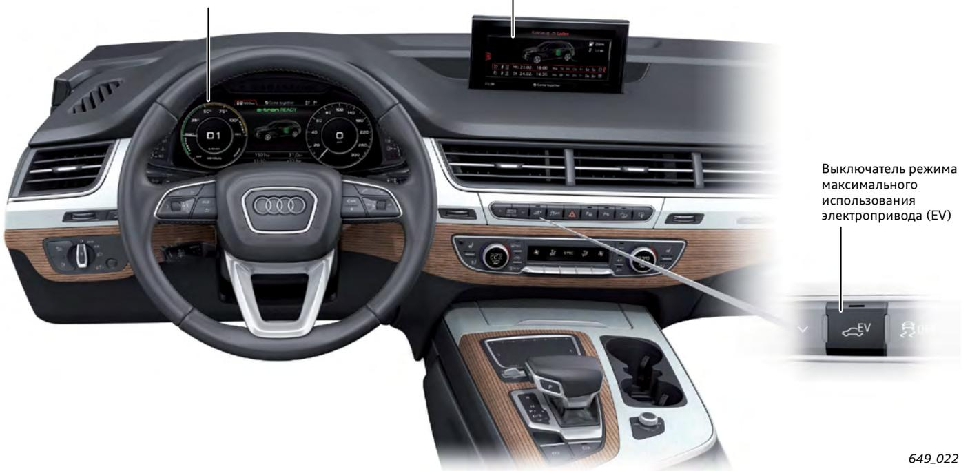
Выключатель режима максимального использования электропривода (EV)
