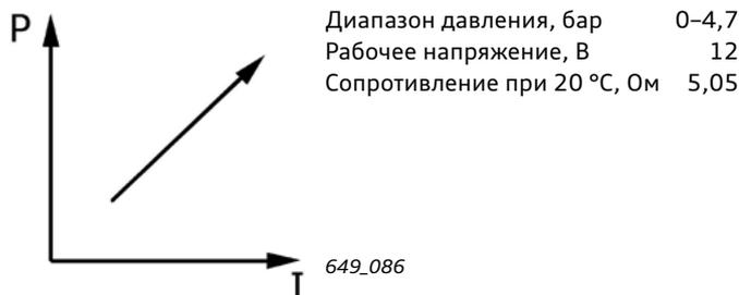
При подаче питания на клапаны регулирования давления с нарастающей характеристикой по мере увеличения тока управления гидравлическое давление регулирования повышается. Управляемые переключающие элементы (тормоза, фрикционные муфты) замыкаются. При отсутствии питания клапаны переключающих элементов открыты, т. е. переключающие элементы не имеют силового замыкания.
