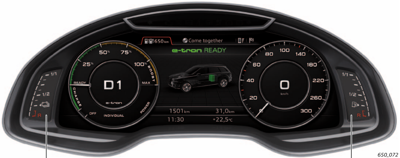
Ladestandsanzeige State of Charge (SOC) der Hybridbatterie
