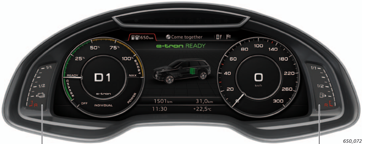
Indicador del nivel de carga State of Charge (SOC) de la batería del sistema híbrido
