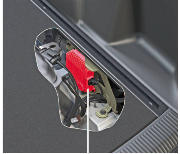
Unidad de control para generación de sonoridad de motor J943
