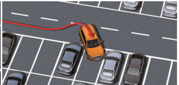
Einparkvorgang mit direkter Ansteuerung des Querparkplatzes
