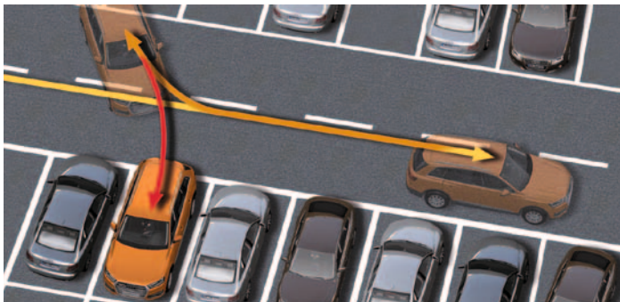
Einparkvorgang nach Vorbeifahrt an einem Querparkplatz
